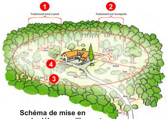
Schéma de mise en oeuvre du débroussaillage
